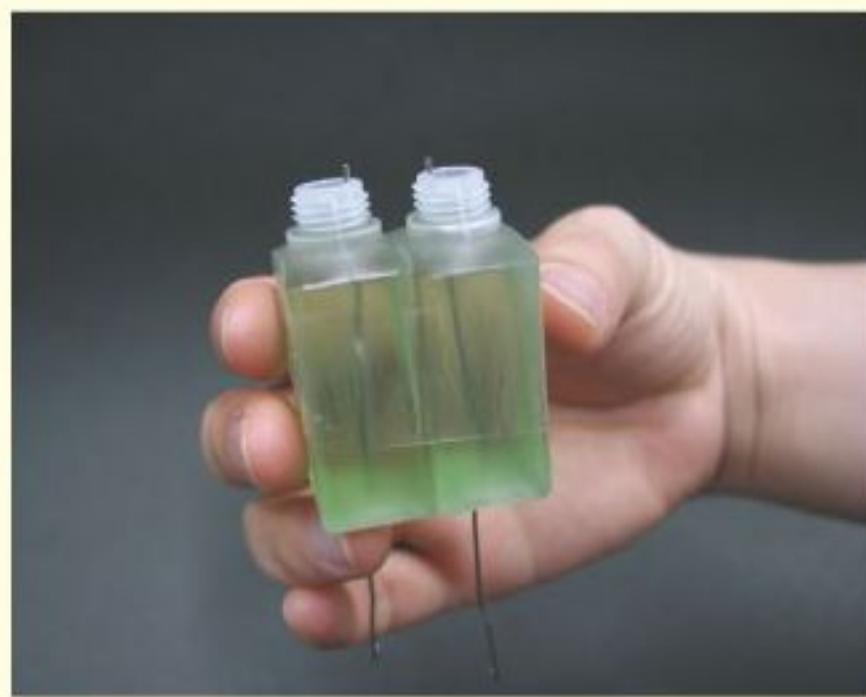
⑤ 醤油さしの口を残った硫酸ナトリウム水溶液に浸しながら、電池(9V)に5分間つなぐ。
