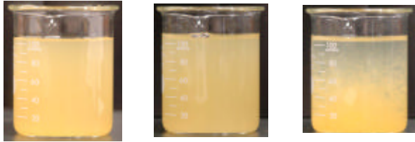
写真2 炭酸ナトリウム水溶液 1.00 cm 3 を加え pH6.1 に調整した状態。左から直後、30 秒後、60 秒後の状態。<color>
