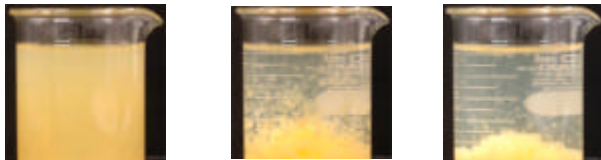
写真3 炭酸ナトリウム水溶液 1.45 cm 3 を加え pH7.0 に調整した状態。左から直後、30 秒後、60 秒後の状態。<color>
