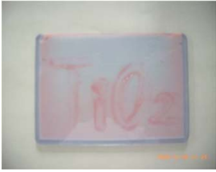
図3 浮かびあがる \text{TiO}_2 の文字（太陽光照射開始から 10 分後）
