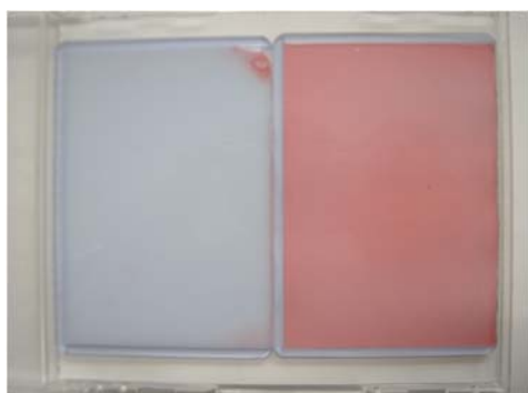
図2 \text{TiO}_2 -食紅寒天ゲル試料と食紅寒天ゲル試料の太陽光照射実験
