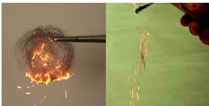
写真3 スチールウールと鉄粉の燃焼<color>
