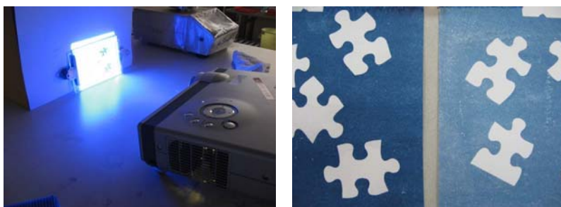
写真2 プロジェクターによる感光の様子(左の写真)とゼラチンの効果 (右の写真: 左側;ゼラチン処理, 右側; 未処理) <color>
