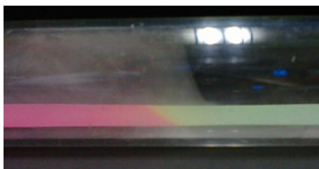
図3 白煙と万能pH試験紙の様子<color> （左側が濃塩酸，右側が濃アンモニア水）
