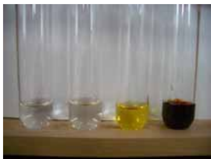
図 3 (左側の試験管から) \text{Fe}^{2+} のみ。 \text{Fe}^{2+} に \text{KSCN} 滴下。 \text{Fe}^{3+} のみ。 \text{Fe}^{3+} に \text{KSCN} 滴下。
