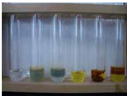
図 1 (左側の試験管から) \text{Fe}^{2+} のみ。 \text{Fe}^{2+} に \text{NaOH} 滴下。 \text{Fe}^{2+} に \text{NH}_3 滴下。 \text{Fe}^{3+} のみ。 \text{Fe}^{3+} に \text{NaOH} 滴下。 \text{Fe}^{3+} に \text{NH}_3 滴下。
