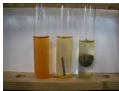
図 5 (左側の試験管から) 封をせずにそのまま放置したもの。釘を 1 本入れたもの。スチールウールを入れたもの。それぞれに \text{KSCN} を滴下した。
