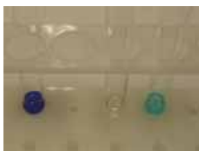
写真2 フェーリング A 液(右) フェーリング B 液(中央) 等量混合物(左)
