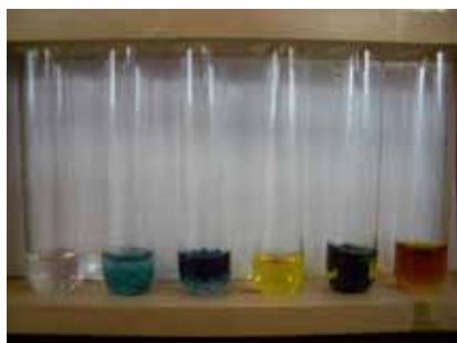
図 2 (左側の試験管から) \text{Fe}^{2+} のみ。 \text{Fe}^{2+} に \text{K}_4[\text{Fe}(\text{CN})_6] 滴下。 \text{Fe}^{2+} に \text{K}_3[\text{Fe}(\text{CN})_6] 滴下。 \text{Fe}^{3+} のみ。 \text{Fe}^{3+} に \text{K}_4[\text{Fe}(\text{CN})_6] 滴下。 \text{Fe}^{3+} に \text{K}_3[\text{Fe}(\text{CN})_6] 滴下。
