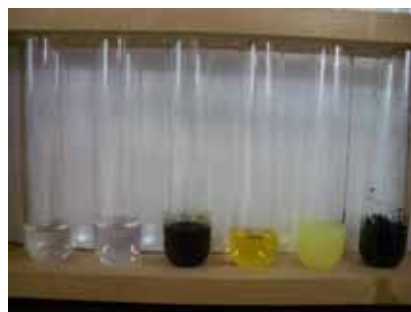
図 4 (左側の試験管から) \text{Fe}^{2+} のみ。酸性条件下の \text{Fe}^{2+} に \text{H}_2\text{S} を加えたもの。塩基性条件下の \text{Fe}^{2+} に \text{H}_2\text{S} を加えたもの。 \text{Fe}^{3+} のみ。酸性条件下の \text{Fe}^{3+} に \text{H}_2\text{S} を加えたもの。塩基性条件下の \text{Fe}^{3+} に \text{H}_2\text{S} を加えたもの。
