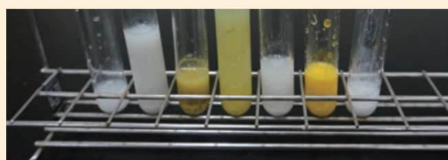
■ \text{Ag}^+ , \text{Pb}^{2+} , \text{Ba}^{2+} の試料の場合 (左から、白色、白色、黄白色、黄白色、白色、黄褐色、白色) (P394, 写真 2)
