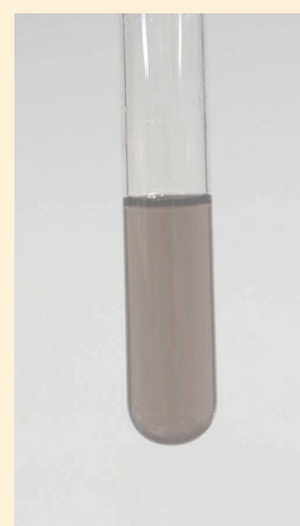
■生成した金ナノ粒子 (P133, 写真 4) 原液では黒にしかみえないので, 100 倍に希釈して撮影した。
