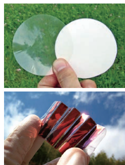
セルロースナノファイバー (CNF) で作られた透明な紙 (上) と、透明な紙で作ったソーラーパネル (下)。(提供：大阪大学 能木雅也教授)
