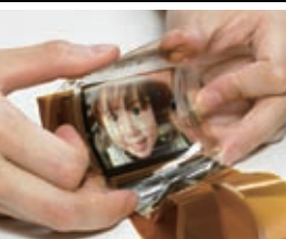
(上)高分子系有機EL材料(住友化学提供)と(下)フレキシブルテレビ試作品(ソニー提供)
