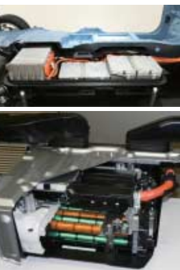
日産リーフのリチウムイオン二次電池とホンダインサイトのニッケル水素電池 (提供:日経 BP 社)
