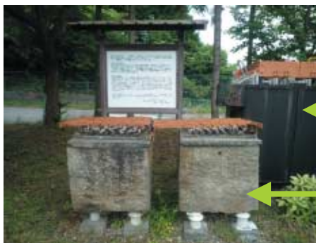
図1 電極付き白御影石製電解槽2点
