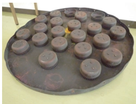
写真3 日本アルコール産業(株)磐田工場所蔵の蒸留塔棚段
