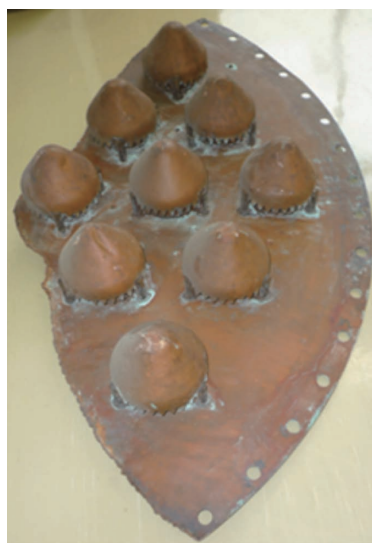
写真2 日本アルコール産業(株)磐田工場所蔵のもろみ塔棚段の一部
