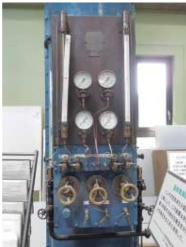
写真1 リンデ式空気液化分留器
