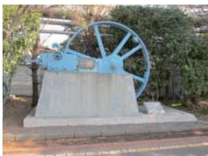
写真6 合成ガス循環機
