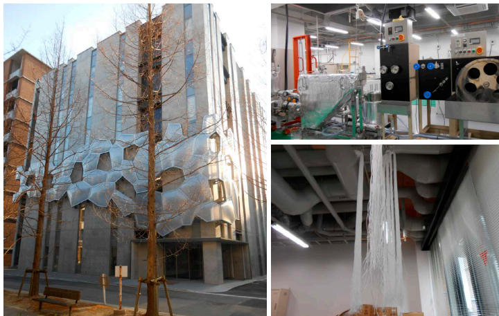
写真 2: 先端膜工学センターが入る神戸大学先端膜工学研究拠点 (左) と膜をつくる大型製膜装置 (右上)、中空糸 (右下)、いずれも筆者撮影
