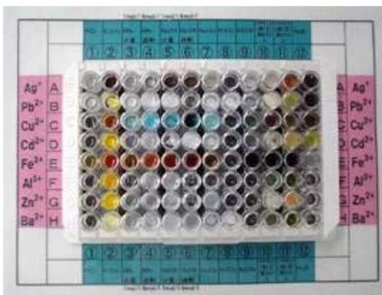
図 6 反応結果を示す台紙上のセルプレート
