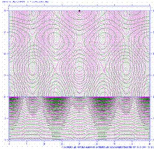
図 7 マルチモード空洞の電界計算の例
