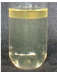
写真2：無水酢酸によるエステルの合成（上層はエステル層、下層は水層）
