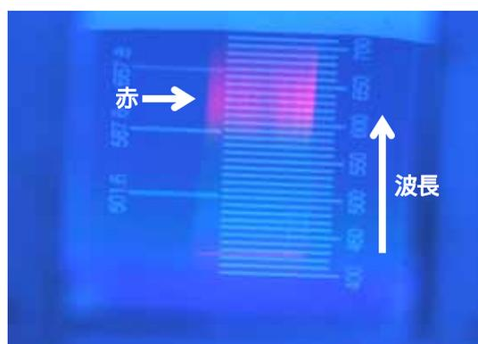
図9 赤色発光する  $\text{CaCO}_3:\text{Ce}^{3+},\text{Mn}^{2+}$  蛍光体の輝線スペクトル
