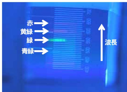
図10 緑色発光する  $\text{CaCO}_3:\text{Ce}^{3+},\text{Tb}^{3+}$  蛍光体の輝線スペクトル
