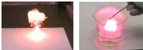
図3 Ti触媒添加NaAlH 4 に対する自然発火性試験(左、高さ1 mから断熱板上への試料落下)及び水との反応性試験(右、水面上の濾紙に試料 2 mmを盛り付け)
