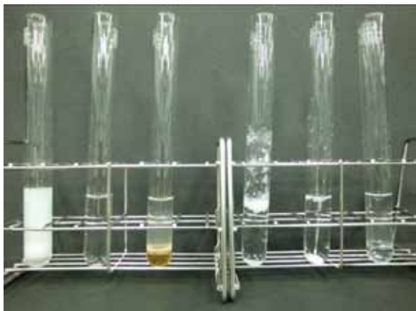
図4 各試薬に蒸留水を加えた様子<color> (左からフェノール, 1-ナフトール, o-クレゾール, サリチル酸, 安息香酸, ベンジルアルコール)
