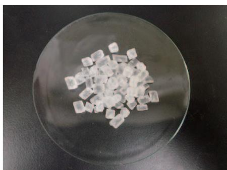
写真1 チオ硫酸ナトリウム五水和物  $Na_2S_2O_3 \cdot 5H_2O$  は粒状結晶であり、その質量は正確に測定できるため、高校の生徒実験のレベルにおいては、その日に調製したものであれば、正確な濃度の水溶液とみなすことができる。
