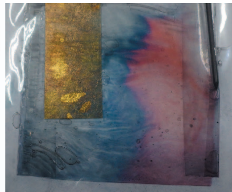
図3 金箔を陽極にして食塩水を電気分解すると、金箔は溶解する。この操作をセロファンの袋中で行い、溶液中に還元剤としてビタミンCを添加すると、セロファン上へ金を青色から赤色のコロイドとして析出させることができる。左はその様子を示す模式図。右は生成した金コロイドの色合いを示す写真。
