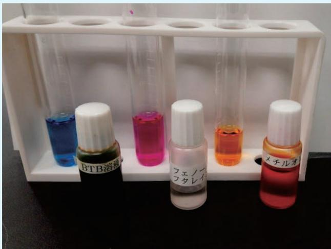
写真4 指示薬による変色の様子
