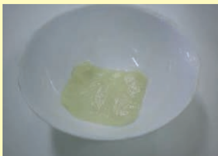
写真1 木綿の布にアニリン、2 mol/L 塩酸をしみ込ませた様子
