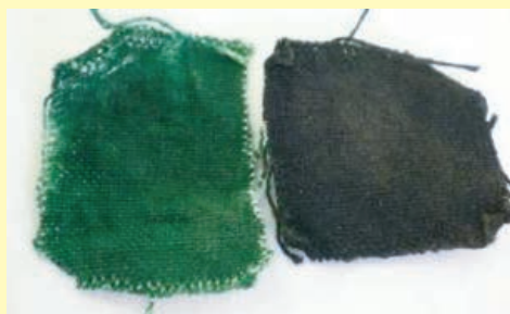
写真2 アニリンブラックの染色の様子。左は、不十分な染色
