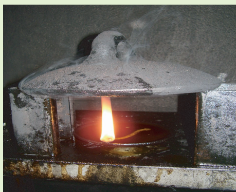
ランプブラック法（左）と、ランプブラック（中央）と松煙（右）の粒子 ×5万倍
