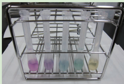
写真1 COD（化学的酸素要求量） 左から 0, 5, 20, 50, 100 mg/L
