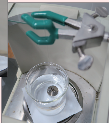
参考写真 金属（シンカー）の体積測定
