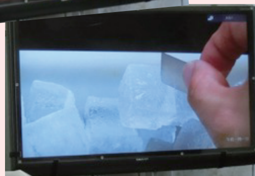
図 1 電気伝導性の違い、 熱伝導性の違いを確かめる実験
