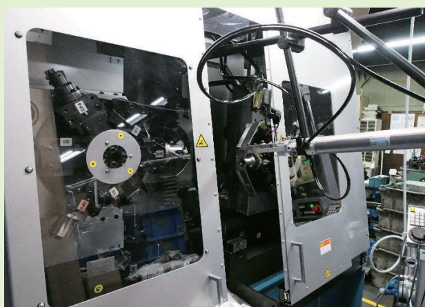
■NC スプリングフォーミングマシン RX-40B（板屋製作所）（P201, 写真 4）
