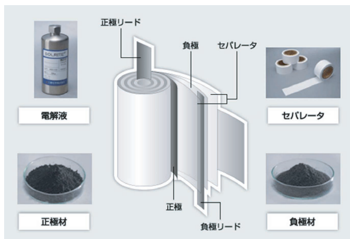
図5 リチウムイオン電池の電極構造
