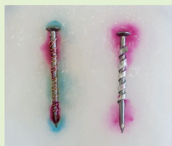
■エバンスの実験（イオン化傾向の違い）（P241, 写真 2） 左：銅線，右：亜鉛板
