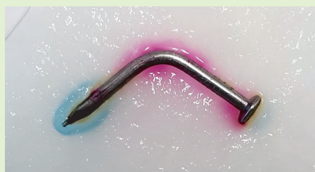
■脱脂綿上の鉄釘の酸化（P240, 写真 1）
