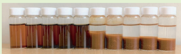
■ 塩化鉄(Ⅲ)水溶液への炭酸カルシウム粉末の添加 (P494, 図 1)
