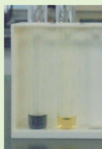
■ 左 水性の青インクを薄めた液 右 塩素を加えた後 (P476, 写真 2)
