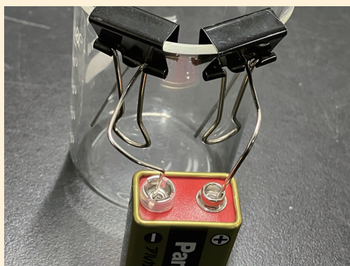
■ 乾電池とクリップ類の接続 (P48, 写真 1)
