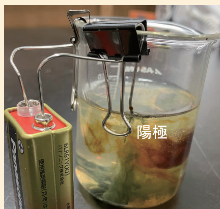
■通電開始 10 分後の陽極の様子 (P49, 写真 5)
