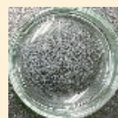
カソードの析出物中 \text{Ag} なし（白濁せず）
