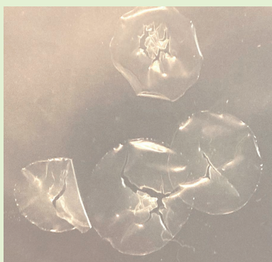
■ ひび割れた膜 (P382, 図 1)
