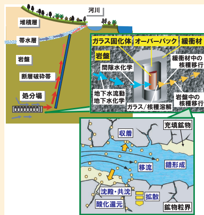
地下水シナリオに基づく放射性物質の移行プロセス (P421, 図 4)
