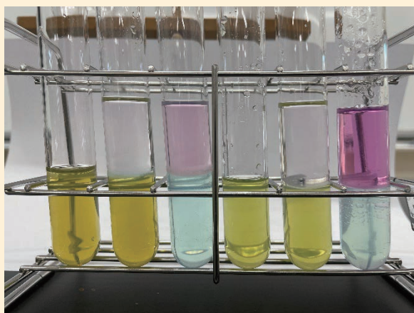
■ 塩化銅(II)水溶液とヨウ素溶液の抽出 (P187, 図2)
