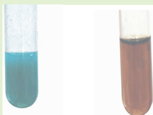
■アンモニア水を加えた場合 (P285, 写真 3) 左: 少量加えた場合 右: 過剰に加えた場合
