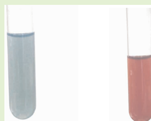
■ヘキサシアニド鉄酸イオン水溶液との反応 (P285, 写真 4) 左: ヘキサシアニド鉄(II)酸イオンの場合 右: ヘキサシアニド鉄(III)酸イオンの場合
