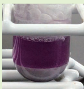
■ニンヒドリン反応の様子 (P57, 写真 6)
