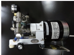
有機合成に対応可能なファインバブル発生装置 (提供:HACK UFB 株式会社, 間瀬暢之教授)。上から, SMX115, ASK3, MA5S。
