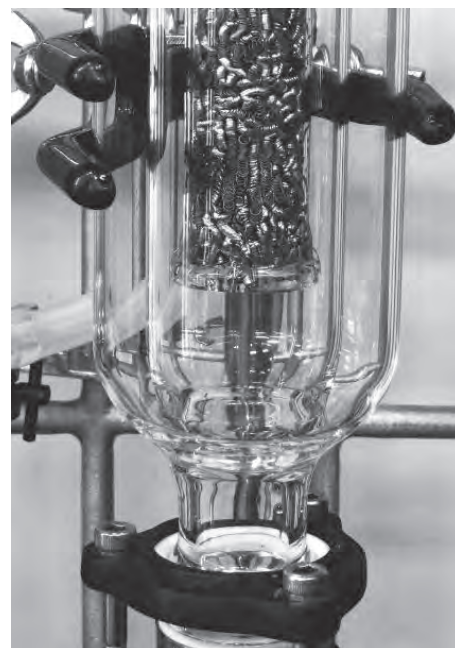
蒸留塔下部。外側は真空ジャケット付保温管によりフラiddiングを防ぎます。
