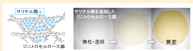
■ サリチル酸を添加したジニトロセルロース膜の黄変 (P5, 図 3)
