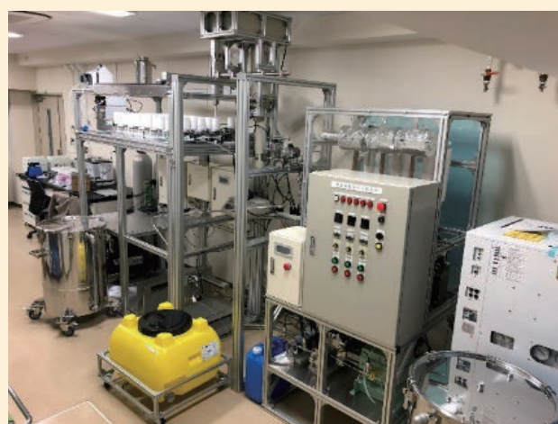
■ スラリー対応型超臨界ソルボサーマル連続フロー全自動合成装置 (P351, 図 5)
