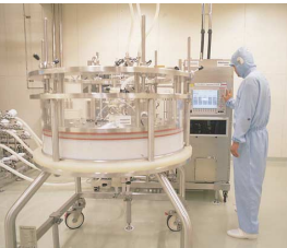
中外製薬宇都宮工場内部。上から1万L培養槽による生産培養工程、培養液の細胞除去工程、カラムクロマトグラフィーによる抗体の純度を高める工程（画像提供：中外製薬）
