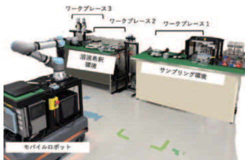
写真1 ロボットを使ったポリマー実験を行うロボットシステムの概要(松原教授, 佐々木助教からの提供による)
