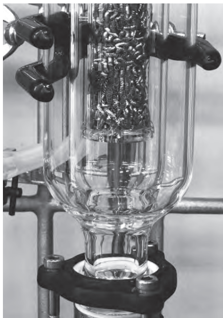
蒸留塔下部。外側は真空ジャケット付保温管によりフラッシングを防ぎます。
