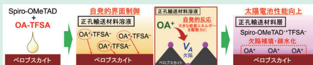
図2 OA-TFSA を正孔輸送材料への添加剤とした自発的ヘテロ界面制御の模式図 2)
