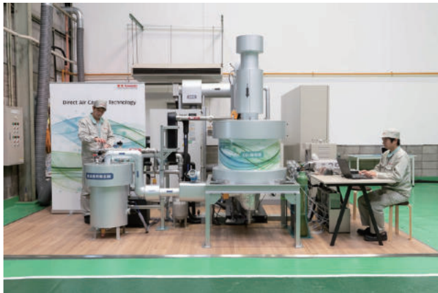
図4 DAC実証試験設備の外観
