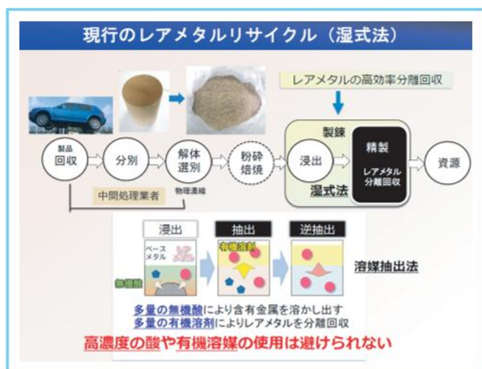
図1 湿式精錬法のプロセスは「浸出」、「抽出」、「逆抽出」の3段階
