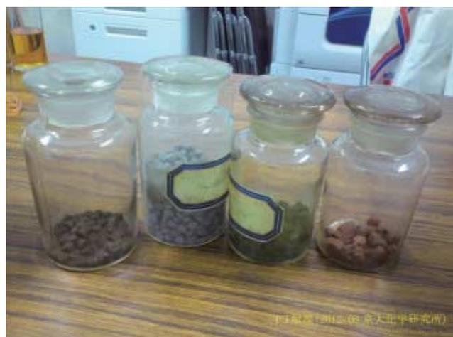
図3 京都大学でつくられた人造石油（上）と触媒（下）の試料（京都大学化学研究所所蔵）
