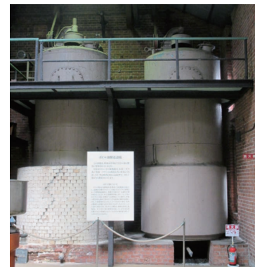
図10 ボイル油製造設備
