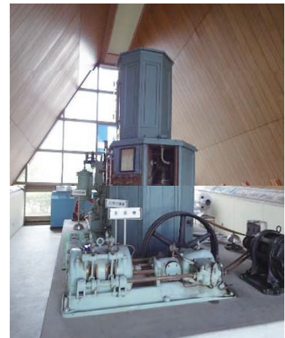
写真1 酸素製造装置 (テイサン記念館展示時) 手前が膨張機
