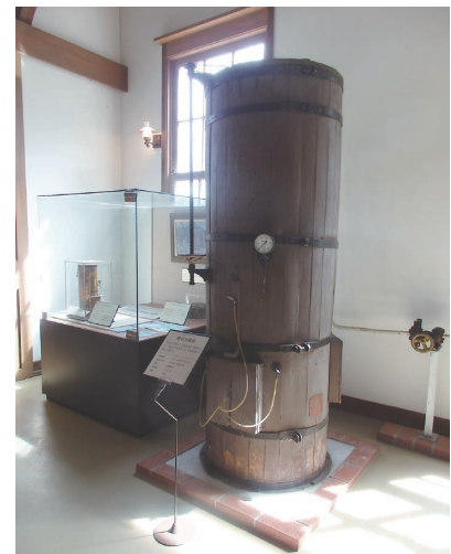
写真2 酸素製造装置の酸素分離機 (日本酸素記念館蔵)
