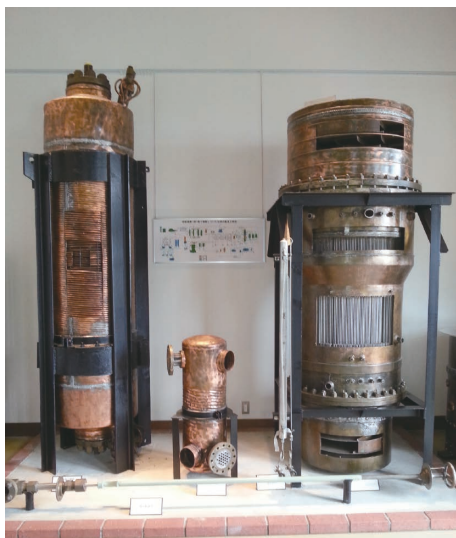
写真4 国産初の液体酸素製造装置① 熱交換器(左)と精留塔の凝縮器(右)
